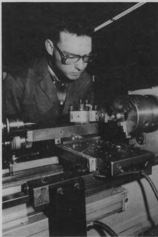
Freesbank reconstructie onderdeel van het uurwerk. Afdeling werktuigbouwkunde MBO Oss.
