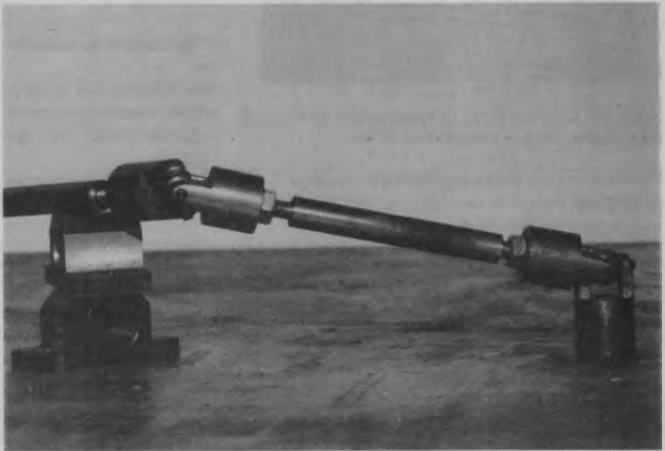
Bij de foto: Aandrijfstang met koppelingsmechanisme voor de beweging van de wijzers. Het geheel vormt de verbinding tussen het uurwerk en het tandwielmechanisme achter de wijzerplaat.
